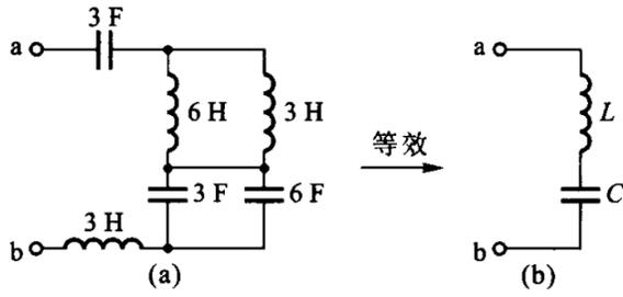
已知图 a 和图 b 等效，求 b 中 L 和 C 的值
