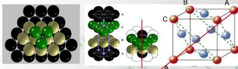
密置层按三层一组相互错开，第四层正对着第一层的方式堆积而成。配位数为12，晶胞所含原子数为4，金属原子空间利用率为74%。
