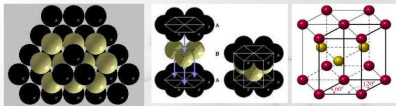
密置层按二层相互错开，第三层正对着第一层的方式堆积而成。配位数为12，晶胞所含原子数为2，金属原子空间利用率为74%。
