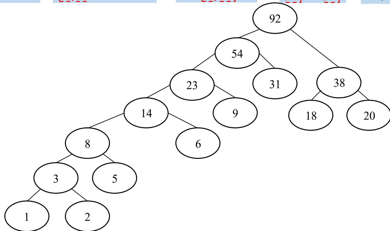
问答题5 用于通信的电文由8个字符组成 $\{a, b, c, d, e, f, g, h\}$ ，字符在电文中出现的频率分别为6, 18, 1, 5, 31, 2, 20, 9。试为这8个字符设计哈夫曼编码。使用0~7的3位等长二进制表示形式是另一种编码方案，对于上述实例比较两种方案的优缺点。
